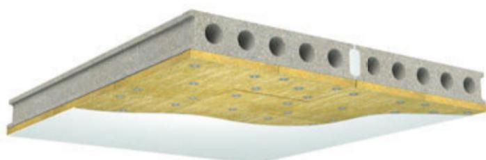
Следующим этапом работ после возведения каркаса здания стало утепление фасада с помощью плит двойной плотности ROCKWOOL ВЕНТИ БАТТС Д толщиной 130 мм. Комбинированная структура плит, имеющих жесткий верхний слой и более легкий нижний, позволяет укладывать их в один слой. Это экономит время и трудозатраты на монтаж, что особо важно для таких площадей фасада, как у «Неба», – 20000 м².
